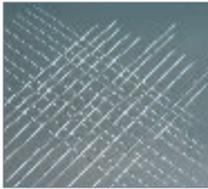
**Test DIN EN ISO 2409** dit test griffe. Après séchage de la laque, l'adhésion est testée par essais de quadrillage pour éprouver la tenue du laquage.
